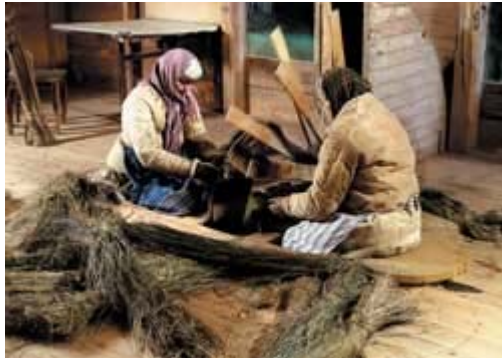
I Växbo finns en gammal tradition med linberedning. Här ett skäkthjul med roterande träknivar. (Foto: Växbo lin)
